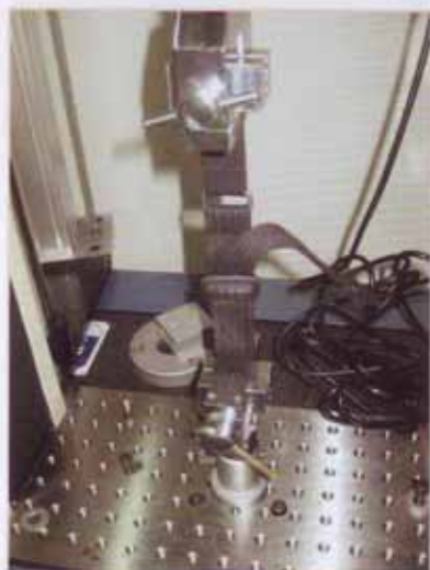
正在进行拉力测试的束缚部件
